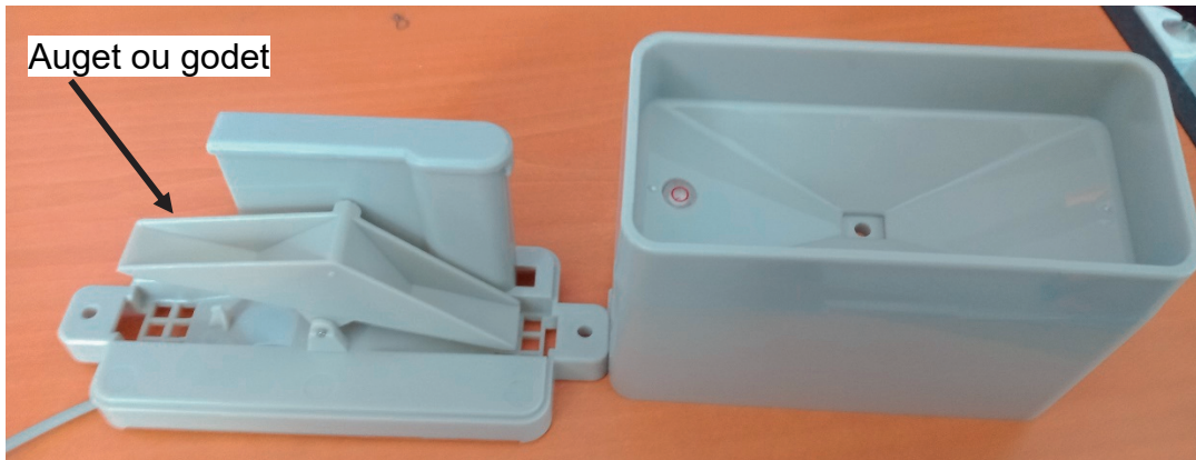
Figure 5 : pluviomètre à augets basculants avec le bloc ouvert
