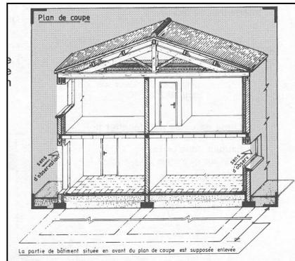
L'emplacement de la coupe doit permettre de montrer le plus grand nombre possible de détails de construction :
